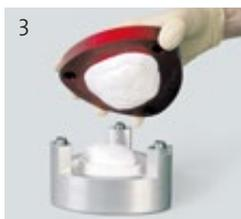
3 Appliquer le plâtre sur le modèle et le couvercle du POLYMASTER et fermer.
