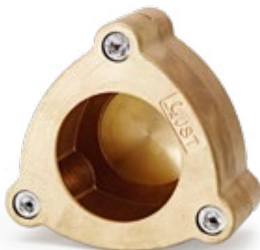
Die Küvette JST wurde in Zusammenarbeit mit ZTM Jürg Stuck entwickelt. Drei Innensechskantschrauben halten die Küvettenhälften zusammen und machen einen umständlichen Küvettenbügel überflüssig. Konische Stahlführungen zentrieren das Küvetten-Ober- und Unterteil spaltfrei aufeinander. Bei der Anwendung der AESTHETIC Intensive Colors (mehrfarbiges Stopfen der Gingiva) kann durch die Möglichkeit des asymmetrischen Schliessens eine Verpressung verhindert werden.
