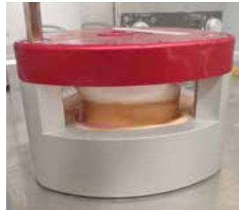
Afb. 17: In de PolyMaster geplaatste modellen (voor koud persen)
