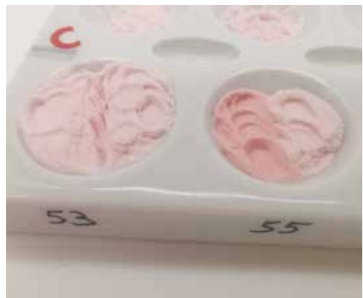
Afb. 21a en b: Individualisering van de rode esthetiek met behulp van verschillende kunststoffen uit het assortiment van Candulor. Mengten van de polymeren 53, 55 en intensief kleurpoeder (verhouding 1:1) met het basismateriaal 34
