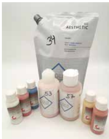
Afb. 21a en b: Individualisering van de rode esthetiek met behulp van verschillende kunststoffen uit het assortiment van Candulor. Mengten van de polymeren 53, 55 en intensief kleurpoeder (verhouding 1:1) met het basismateriaal 34
